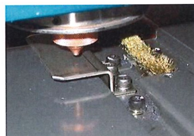
Station automatique de calibration et de nettoyage de la buse
